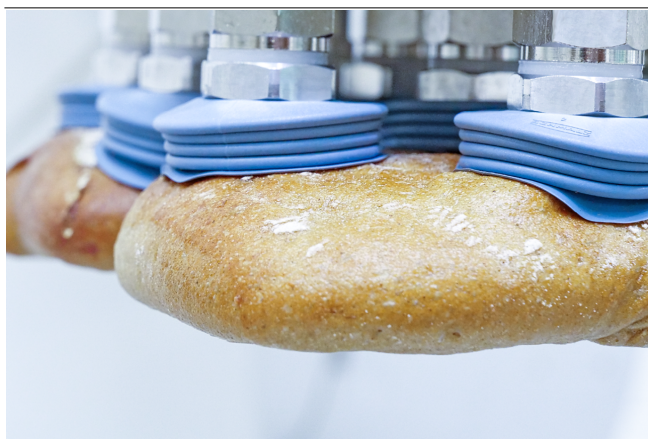
Ventose a soffietto FSDC per la movimentazione di prodotti da forno
